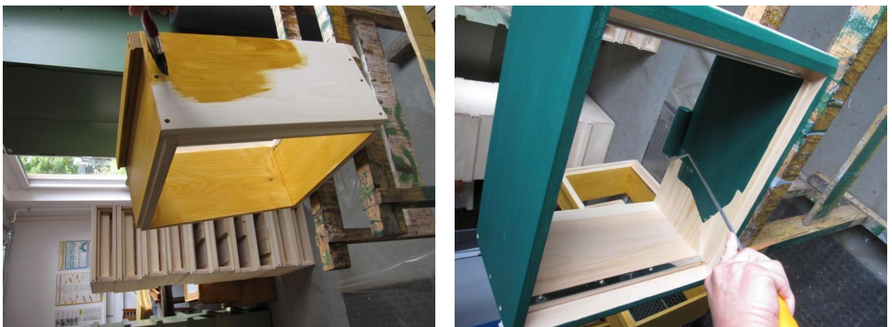
Abb. 5: Auftragen der zu prüfenden Anstriche. Die Anstriche wurden auch im Inneren der Beuten angewendet.
